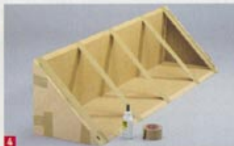
4 Geben Sie Leim in die Schlitze und pressen Sie die Verbindungen mit Paketband, bis der Leim getrocknet ist. Da die großen Flächen der Boxen nicht ...
