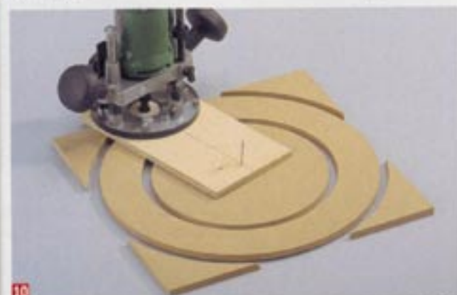
MDF- oder Spanplattenringe für die Bespannung ebenfalls mit der Oberfräse ausschneiden; in mehreren Gängen, um den Fräser nicht zu überlasten
