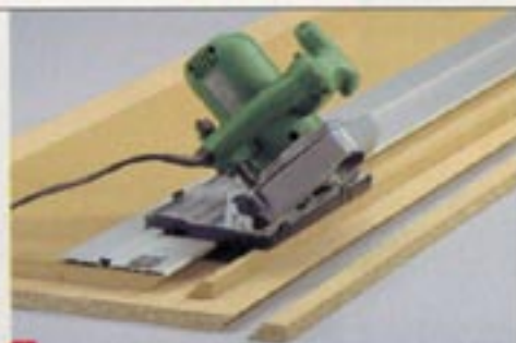
1 Die Dreiecksboxen verfügen über 45°-Kanten an beiden Seiten der Frontplatte und der Seitenwände. Schneiden Sie sie mit der Handkreissäge in der Führungsschiene
