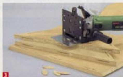
3 Kopfplatte, Seitenwände und Boden mit Flachdübeln verbinden. Falls Sie keine Flachdübelfräse besitzen: ein Winkelschleifer mit Flachdübelvorsatz tut's auch
