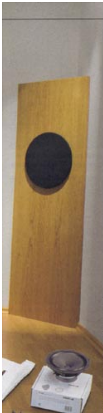
1 Die Dreiecksboxen verfügen über 45°-Kanten an beiden Seiten der Frontplatte und der Seitenwände. Schneiden Sie sie mit der Handkreissäge in der Führungsschiene
