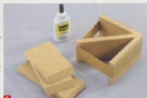
5 ... schwingen dürfen, sind solche Aussteifungen nötig. Passen Sie deren jeweils nur in Grobmaßen angegebene drei Teile vor dem Verleimen mit Paketband genau an
