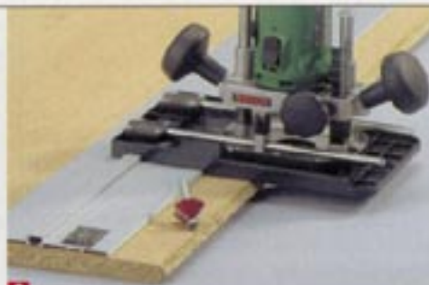
2 Aus optischen Gründen sind die spitzwinkligen Seitenkanten der Fronten nach vorn um 45° angeschrägt. Fräsen Sie diese Schattenfuge mit dem Fasenfräser
