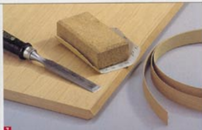
Klebefurnierstreifen auf Seiten- und Oberkanten aufbügeln (Einstellung „Leinen“): Überstände mit dem Schleifklotz und feinem Sandpapier entfernen
